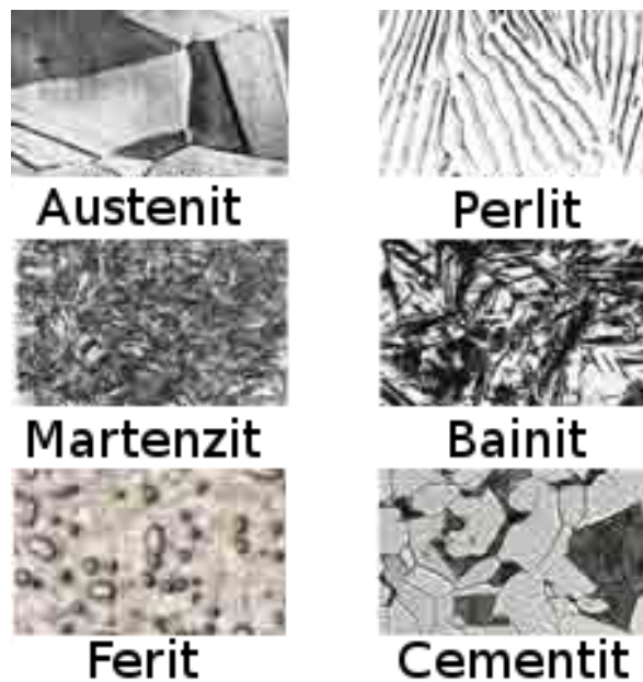
Slika 8.6: Različite kristalne strukture čelika.
