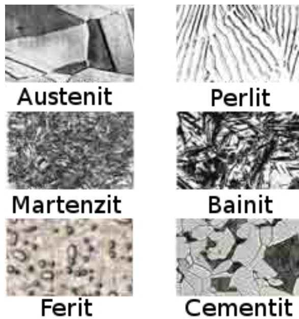
Slika 8.6: Različite kristalne strukture čelika.
