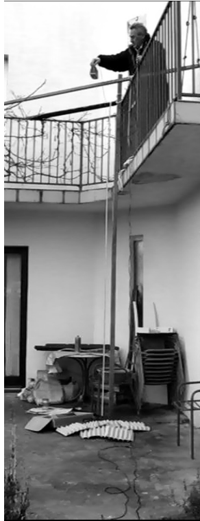
Slika 3.2: Eksperimentalni postav netom prije ispuštanja zvučnika. Vidljiv je zvučnik kojeg pridržava asistent na visini 3,88 m te mikrofona na tlu oko kojeg su poslagane kartonske kutije za jaja.
