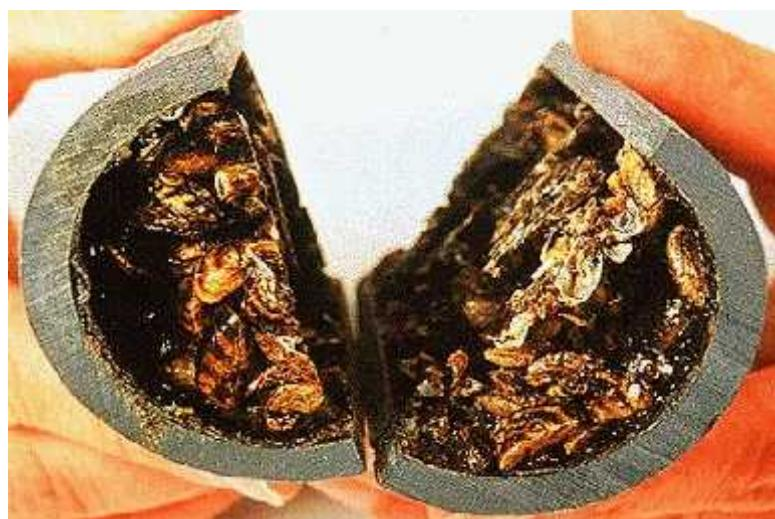
**Slika 3.** Obraštaj vrste *D. polymorpha* unutar vodovodnih cijevi
