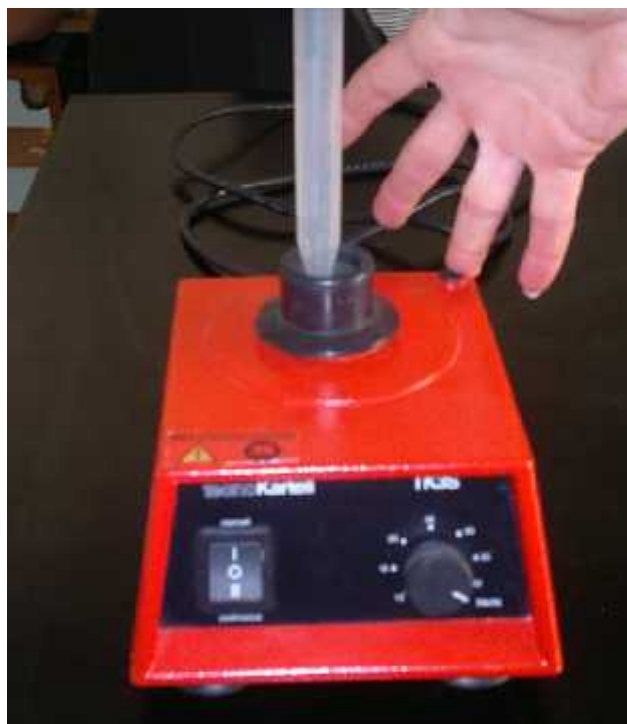
Slika 7. Kartell TK3S homogenizator (odvajanje imobiliziranih bakterijskih stanica)
