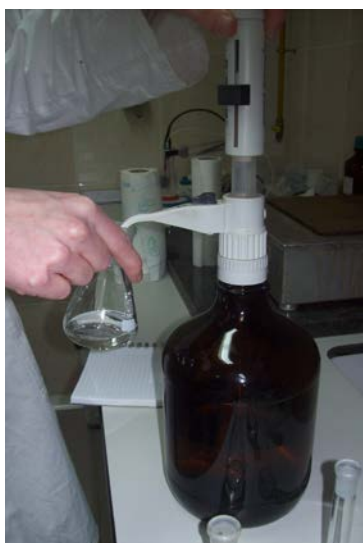
Slika 19. Titracija otopinom srebrnog nitrata za određivanje klorida (Vlastita fotografija)
