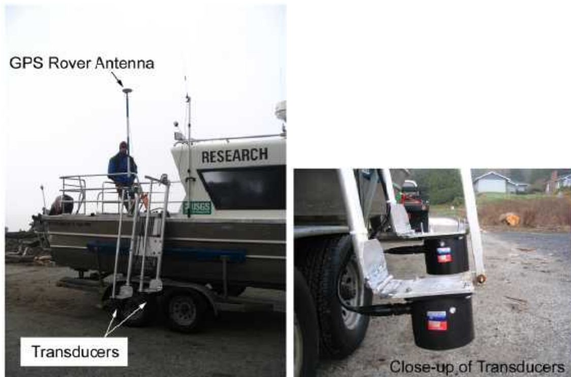
Slika 8. Akustična oprema montirana na bok broda (Stevens i sur., 2008).
