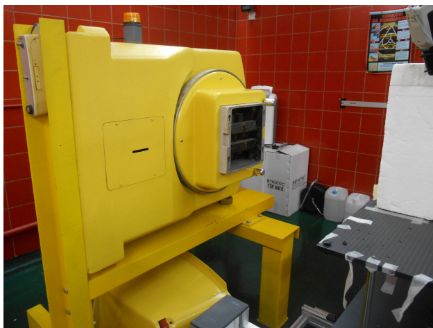
(a) Kućište sa izvorom ^{60}\text{Co} .
