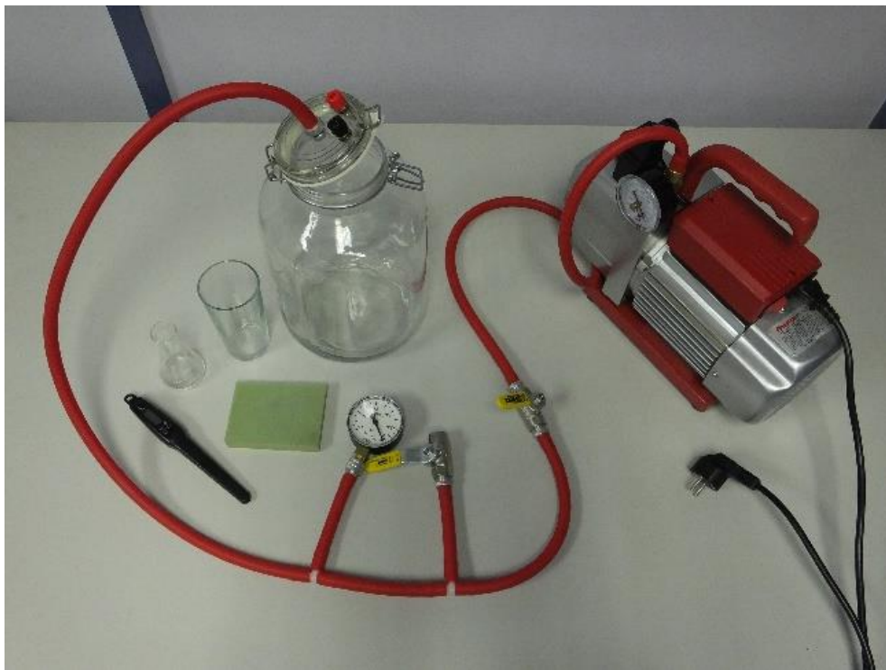
Slika 4.3.1. Eksperimentalni postav za vježbu voda u vakuumu
