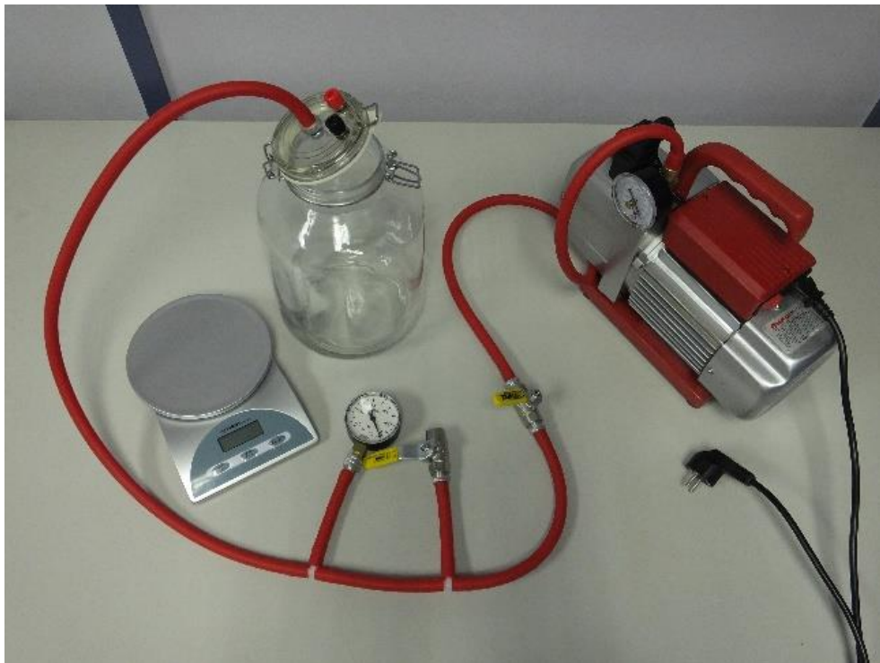
Slika 4.6.1. Eksperimentalni postav za vježbu vaganje zraka
