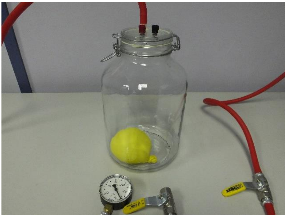
Slika 4.1.2. Balon u staklenci prije vakuumiranja
