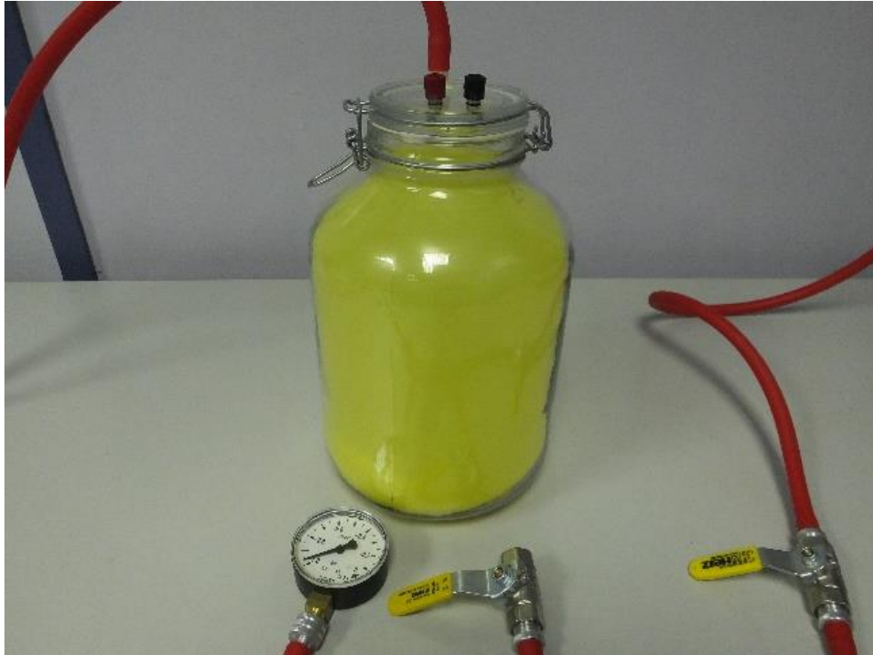
Slika 4.1.3. Balon u staklenci nakon vakuumiranja
