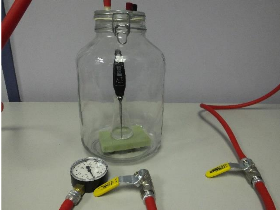
Slika 4.3.2. Erlenmeyerova tikvica s destiliranom vodom i termometrom na spužvici u staklenci
