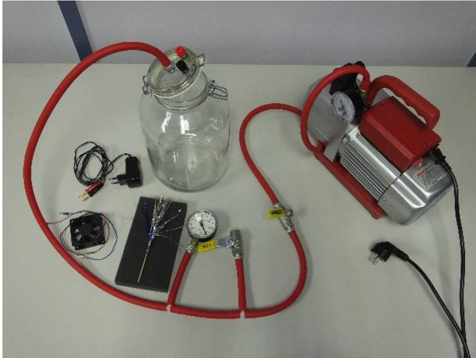
Slika 4.2.1. Eksperimentalni postav za vježbu vjetar u vakuumu
