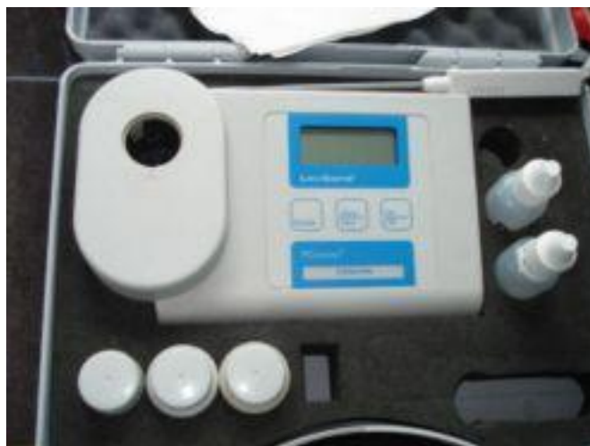
Slika 6. Kolorimetar za mjerenje slobodnog rezidualnog klora (Foto: Martina Kurečić)
