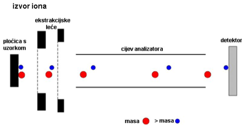
Slika 2.6. Prikaz principa rada linearног analizatora
