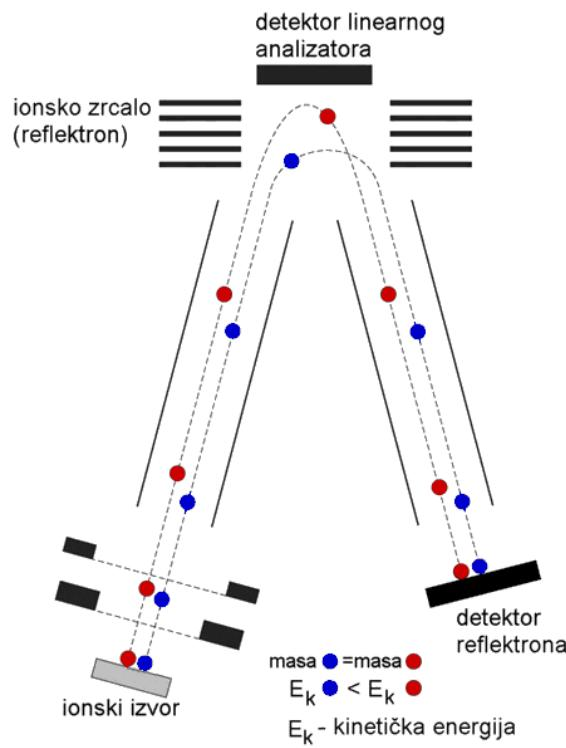
Slika 2.7. Prikaz principa rada analizatora s ionskim zrcalima tзв. reflektrom.
