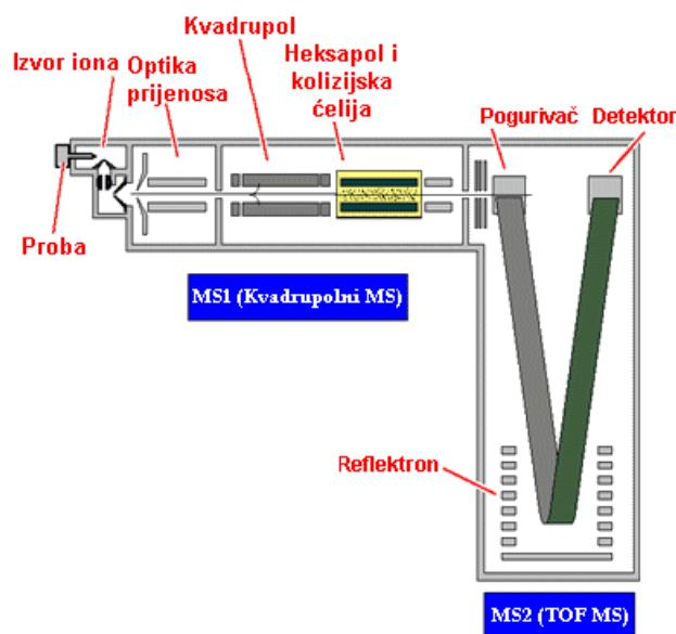
Slika 2.8. Presjek hibridnog analizatora masa Q-TOF
