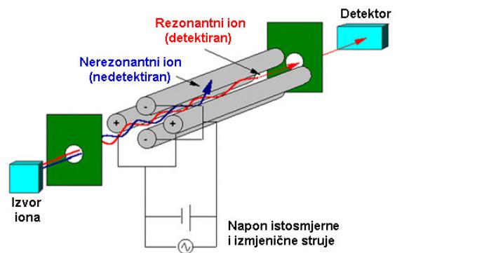
Slika 2.5. Shema kvadrupolnog analizatora masa.
