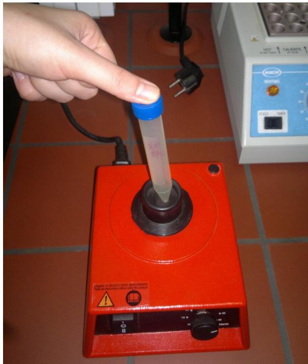
Slika 8. Kartell TK3S homogenizator (odvajanje imobiliziranih bakterijskih stanica sa crvenice)
