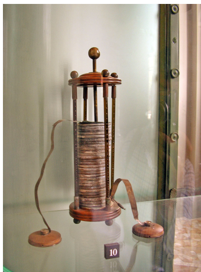
Slika 2.4: Muzejski primjerak električne baterije Alessandra Volte izložen u muzeju Tempio Voltiano u njegovom rodnom gradu Comu.
