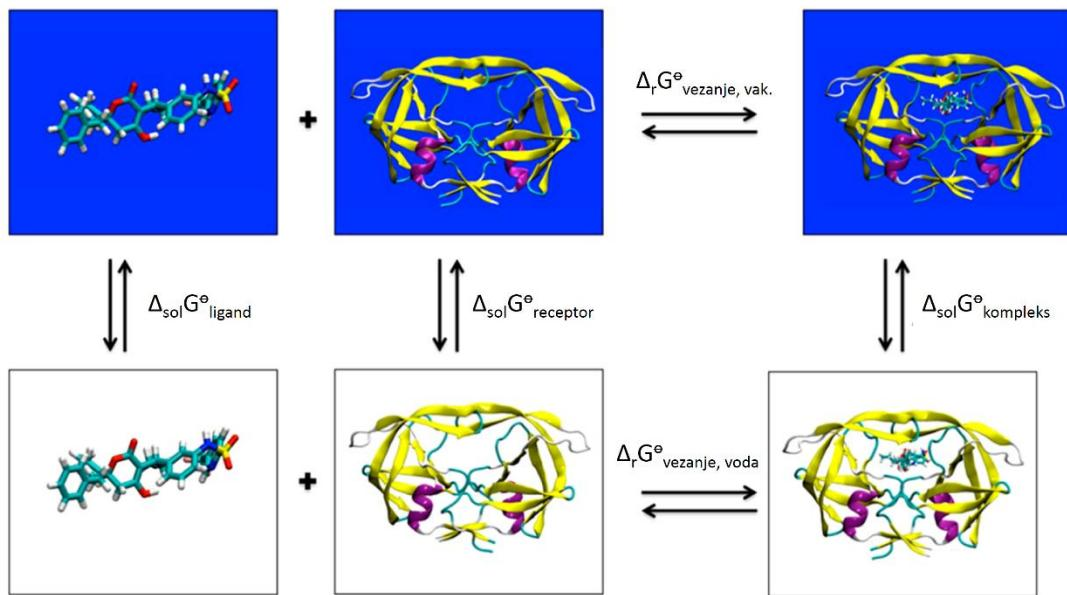
**Slika 12.** Termodinamički ciklus kod određivanja energije vezanja MM-PBSA metodom. Plava pozadina predstavlja specije u vodenom mediju, a bijela u vakuuumu. Slika je preuzeta iz rada Millera i suradnika.<sup>100</sup>
