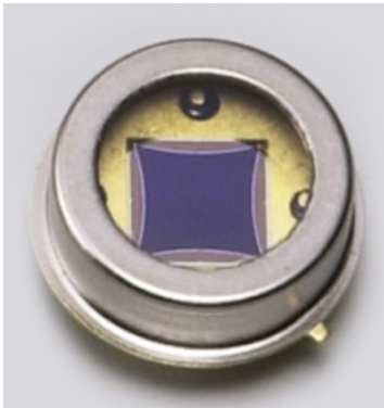
Slika 4.3: Korištena PIN (foto)dioda. Za potrebe ovog eksperimenta uklonjeno je zaštitno stakalce iznad aktivne površine diode [13].
