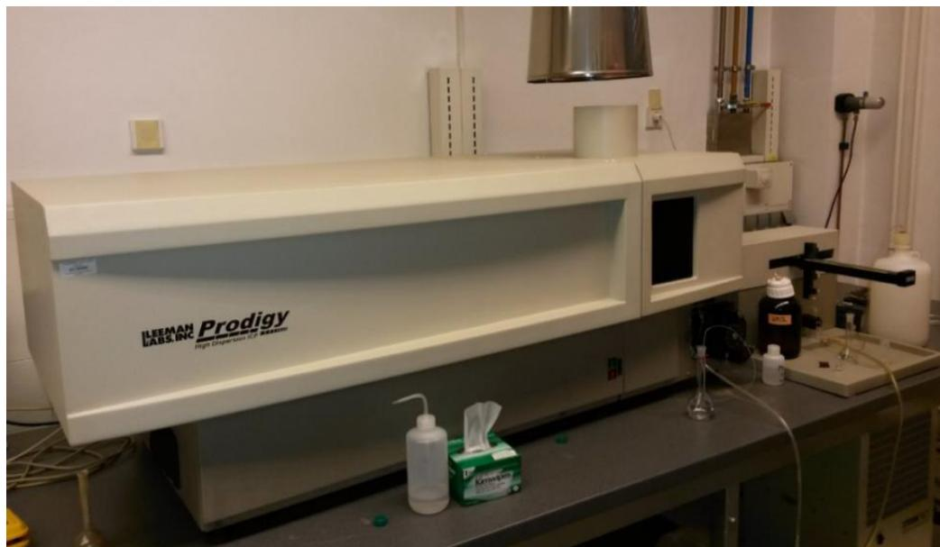
*Slika 3. Optički emisijski spektrometar Prodigy High Dispersion ICP
