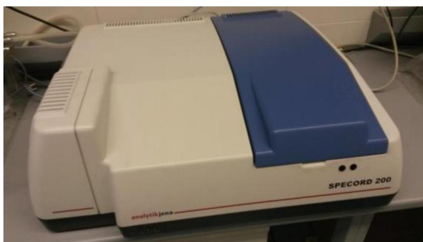
*Slika 2. UV/VIS spektrofotometar SPECORD 200 Analytik-JENA, De*
