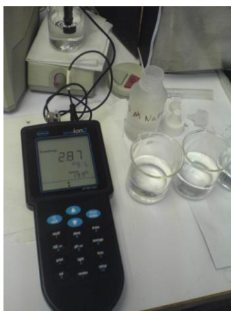
Slika 2.13: Mjerenje kapaciteta izmjene kationa.
