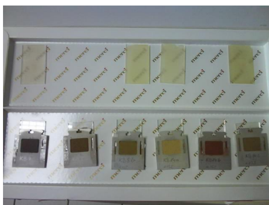
Slika 2.11: Uzorci pripremljeni za rendgensku difrakciju na prahu.
