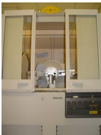
Slika 2.10: Rendgenski difraktometar Philips PW3040/60 X'Pert Pro (Izvor: http://www.pmf.unizg.hr/geol/o_nama/mineralosko-petrografski_zavod/oprema/rendgenski_laboratorij )
