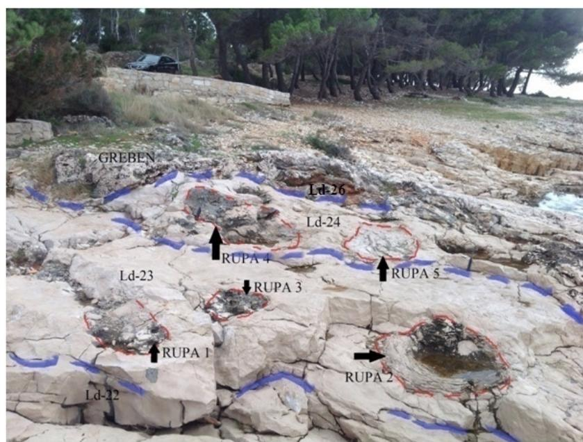
**Slika 17** Područje uzorkovanja na emerzijskoj površini Ld-24 za potrebe određivanja udjela kalcijevog karbonata. Označene su rupe 1–5 s vidljivim ispunama koje su uzorkovane (uzorci Ld-25a i Ld-25d), a prodiru u sloj Ld-24 i u njegovu podinu.
