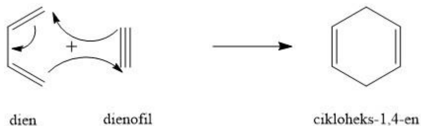
Slika 14. Općeniti mehanizam Diels-Alderove reakcije sa alkinom kao dienofilom
