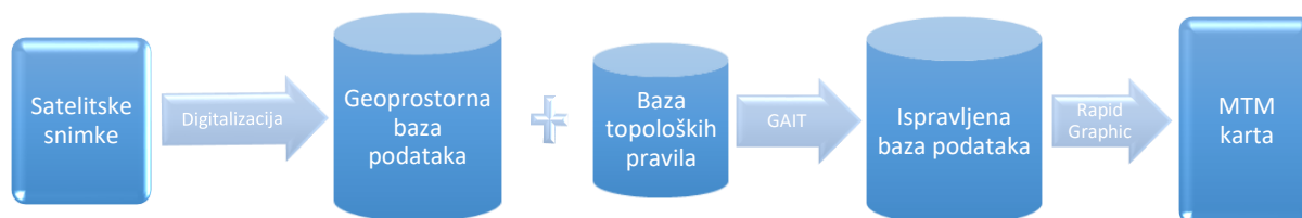
Sl.2. Shematski prikaz procesa izrade topografskog zemljovida u MTM standardu
