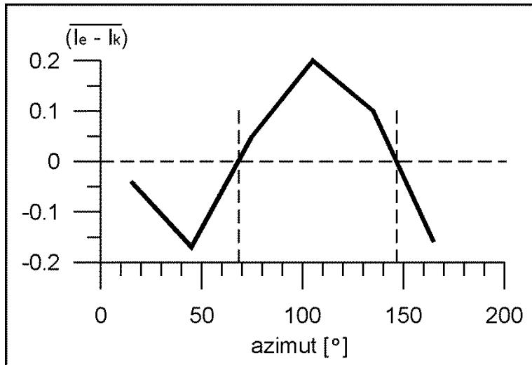
**Slika 3.4.** Azimutalna ovisnost srednjih razlika empirijskih intenziteta i intenziteta izračunatih za izotropni model. Vrijednosti su računate za klase širine  $30^\circ$ .
