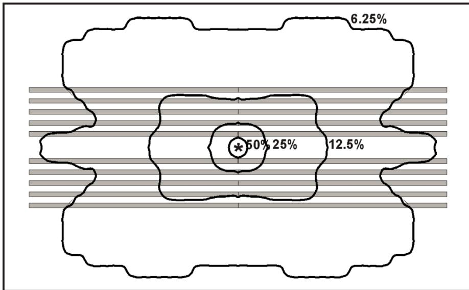
**Slika 4.4.** Izolinije amplitude vala u postocima amplitude u žarištu za slučaj od pet paralelnih rasjednih zona (sive crte) sa svake strane žarišta. Reflektirani i direktni valovi se ne superponiraju. Nije prikazan rasjed na kojem se dogodio potres. Parametri kao na slici 4.3.
