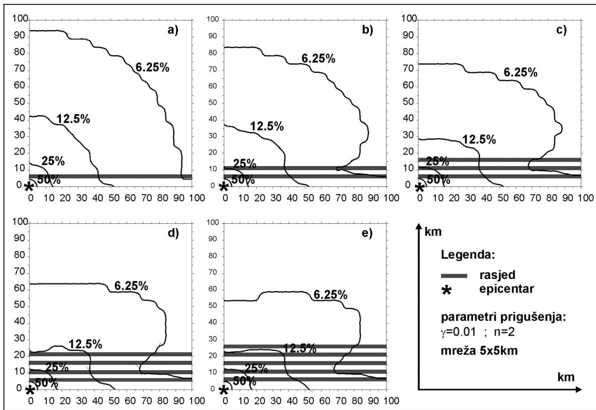
**Slika 4.6.** Izolinije amplitude (samo prvi kvadrant) superpozicije transmitiranog vala i valova reflektiranih na svim rasjedima kao funkcije broja paralelnih rasjeda i upadnog kuta. Broj rasjeda raste od (a) 1 do (e) 5. Označene su izolinije koje tvore geometrijski niz tako da 50% od  $A_o$  odgovara intenzitetu  $I = I_o - 1$ , 25% odgovara  $I_o - 2$ , 12.5% je  $I_o - 3$ , a 6.25%  $I_o - 4$ .  $I_o$  je intenzitet u epicentru.
