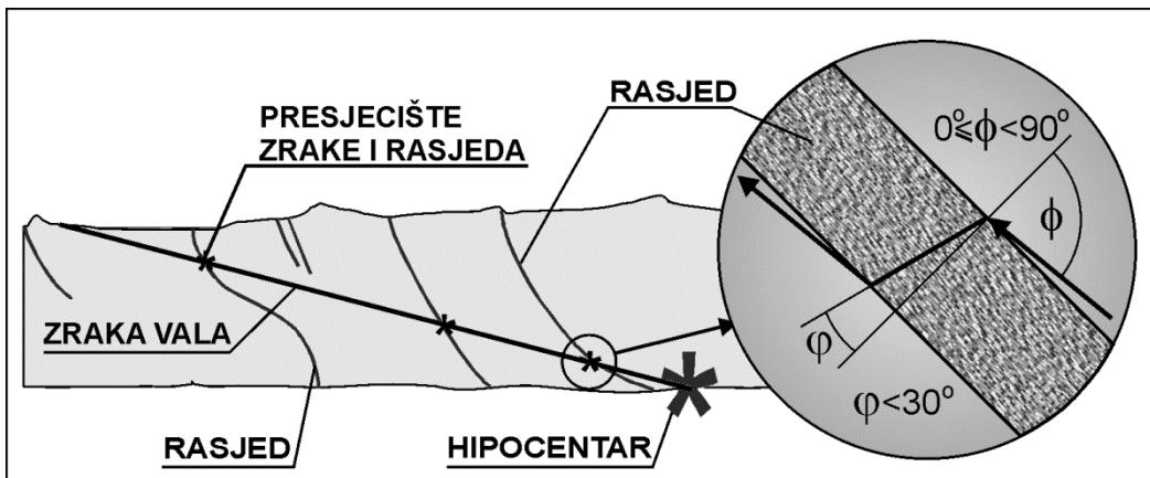
**Slika 5.3.** Vertikalni presjek rasjedne zone. U najgorem mogućem slučaju kad zraka vala upada skoro paralelno s rasjednom plohom lomi se pod kutem od  $30^\circ$ . Staza vala unutar rasjedne zone je dulja od širine zone za manje od 16%.
