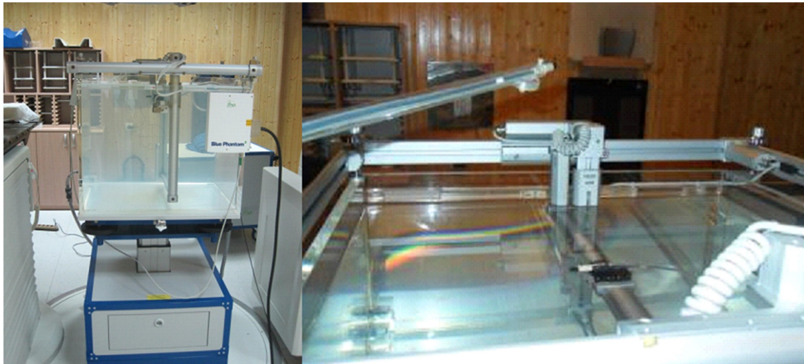
Slika 3.7. Vodeni fantom IBA Blue 2 s ionizacijskim komorama malih volumena u mjernom postavu.
