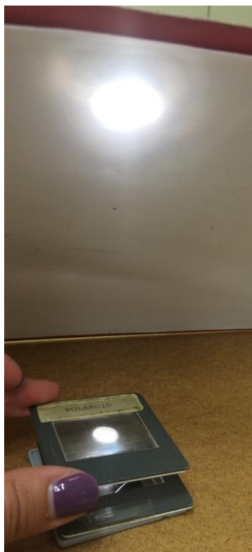
Slika 3.15: Polaroidi su postavljeni međusobno paralelno
