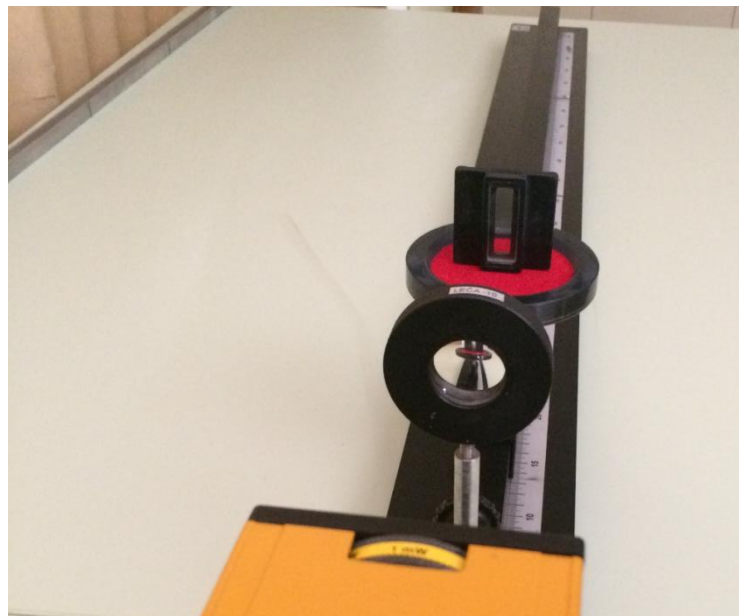
Slika 3.3: Laser, divergentna leća i Fresnelova biprizma
