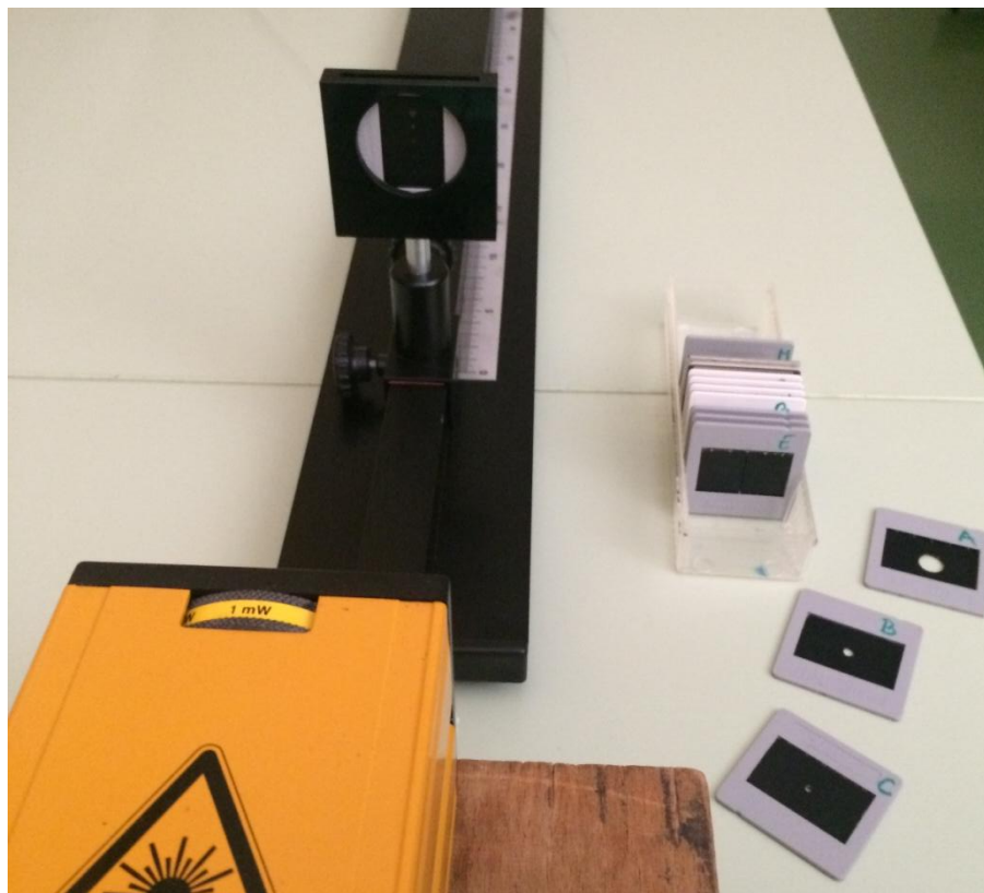
Slika 3.6: Postav za promatranje ogiba svjetlosti na pukotini
