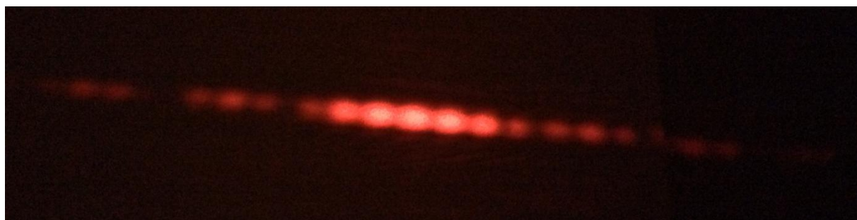
Slika 3.10: Ogib svjetlosti na pravokutnoj pukotini
