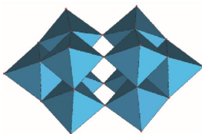
Slika 12. Dekavolframatna struktura [W_{10}O_{32}]^{4-} prikazana poliedarskim modelom pri čemu se atomi volframa nalaze u središtu plavo obojenih oktaedara, kisikovi atomi su prikazani crvenom bojom 10
