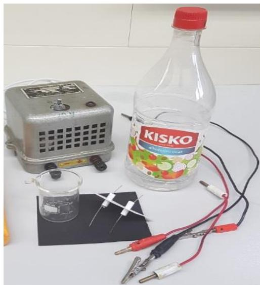
Slika M4. Pribor i kemikalije potrebni za provedbu elektrolize prema TVRDNIJ 4.
