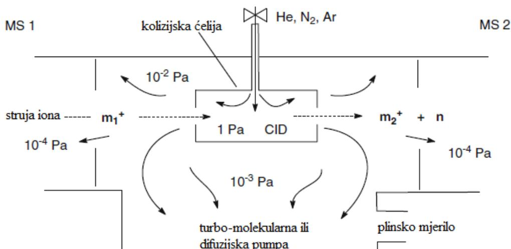
Slika 13. Shematski prikaz kolizijske ćelije za provođenje eksperimenata kolizijom izazvane disocijacije (CID).<sup>1</sup>
