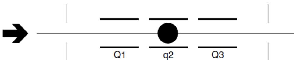
Slika 7. Shema trostrukog kvadrupolnog analizatora masa; Q = analizator masa, q = kolizijska ćelija.<sup>2</sup>
