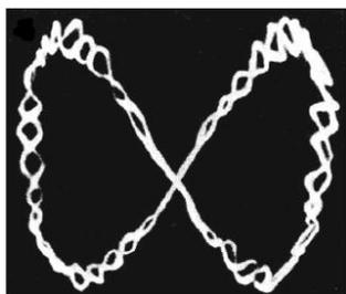
Slika 12. Fotografija putanje iona nabijenih čestica aluminija u trodimenzijskoj ionskoj stupici.<sup>1</sup>
