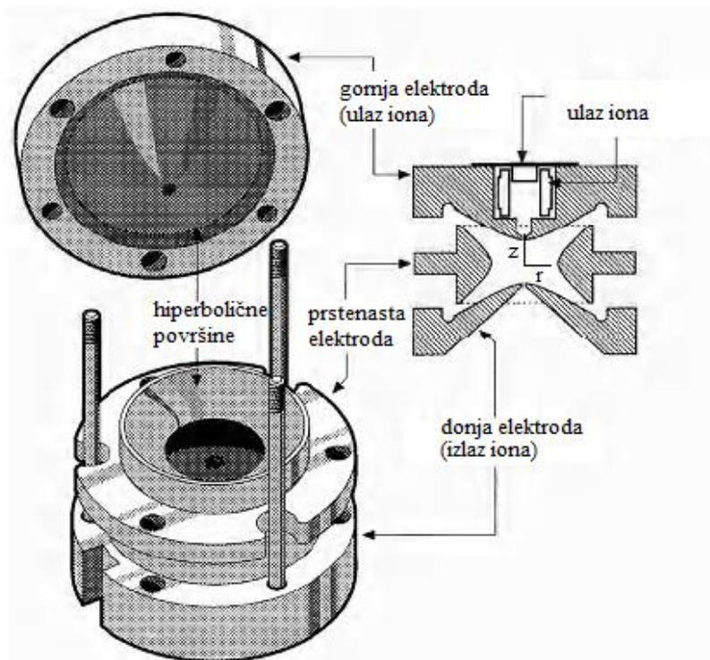
Slika 11. Shematski prikaz trodimenzijske ionske stupice i pripadajućih elektroda.<sup>5</sup>
