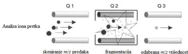
Slika 9. Shematski prikaz analize iona pretka.<sup>1</sup>
