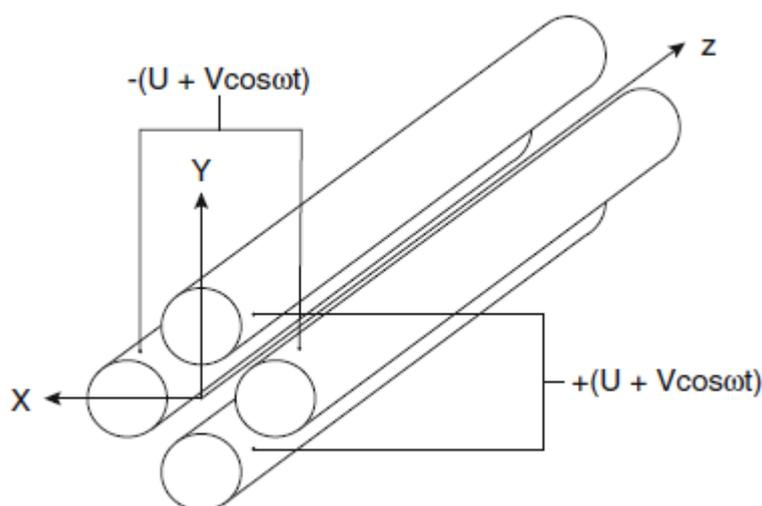
Slika 5. Shematski prikaz kvadrupolnog analizatora masa.  $U$  = istosmjerni napon,  $V$  = izmjenični napon,  $\omega$  = frekvencija izmjeničnog napona.<sup>1</sup>
