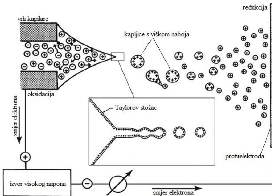
Slika 1. Shematski prikaz elektroraspršenja.<sup>1</sup>
