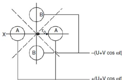
Slika 6. Shema poprečnog presjeka kvadrupolnog analizatora masa s cilindričnim elektrodama.<sup>1</sup>
