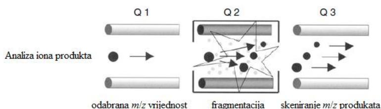
Slika 8. Shematski prikaz analize iona produkta.<sup>1</sup>
