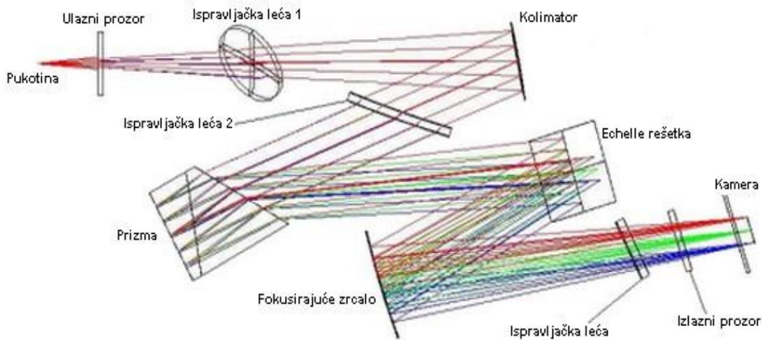
Slika 31: Optički izgled Mechelle 5000 spektrometra. Mechelle ima nekoliko optičkih komponenti dizajniranih tako da smanje učinak aberacija. Takav dizajn osigurava točke koje odgovaraju točno individualnim valnim duljinama koje su dobro fokusirane na izlaznoj žarišnoj ravnini što je ključno da bi se osigurala dobra razlučivost i minimalna preklapanja između susjednih spektralnih redova. [16]
