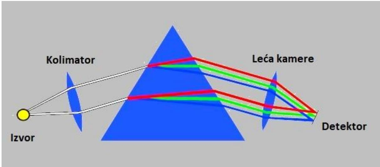
Slika 6: Pojednostavljen prikaz spektrometra s prizmom i njegovi dijelovi. [6]
