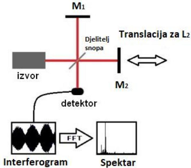
Slika 38: Princip rada Fourier-transform spektrometara. Dijelovi su: izvor, zrcalo  $M_1$  koje je fiksno, zrcalo  $M_2$  koje je pomično i DS- djelitelj snopa.  $L_2$  dužina puta koja se kontinuirano i uniformno mijenja zbog zrcala  $M_2$  koje se pomiče konstantnom brzinom  $v$ . [19]
