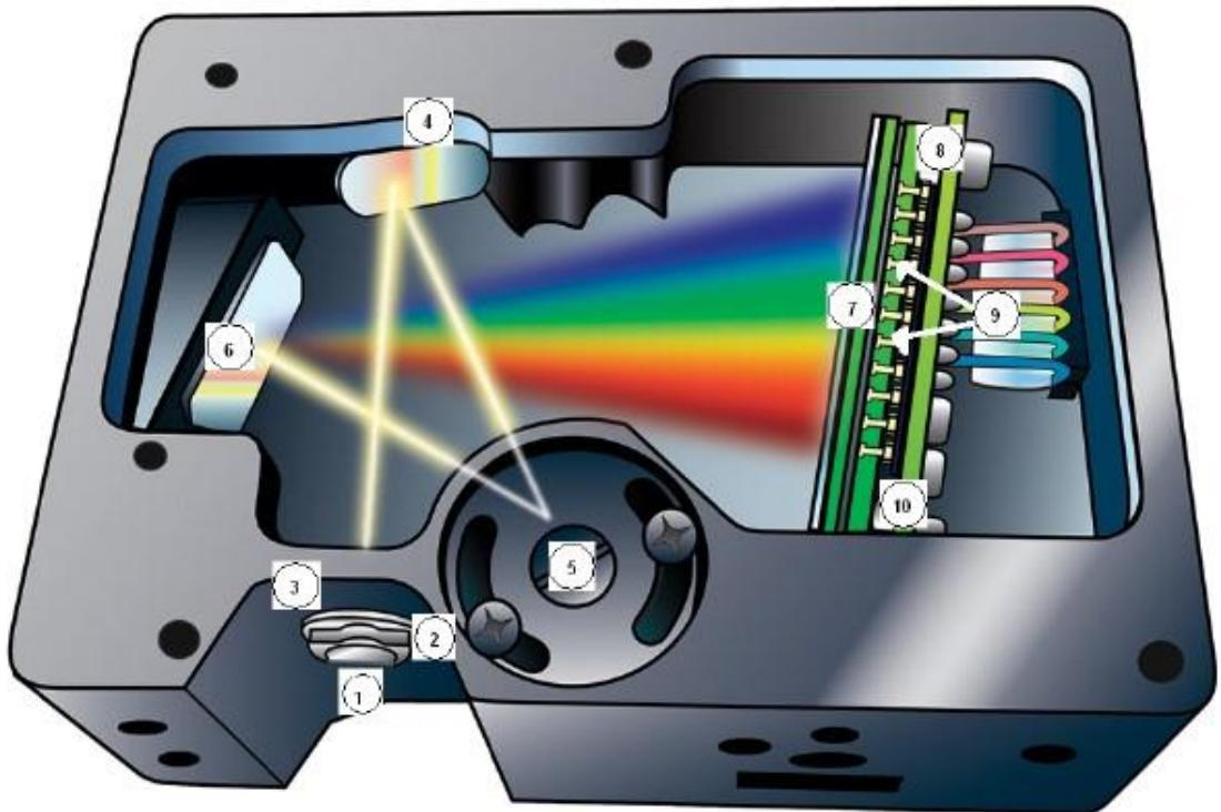
Slika 29: Poprečni presjek USB spektrometra. [15]
