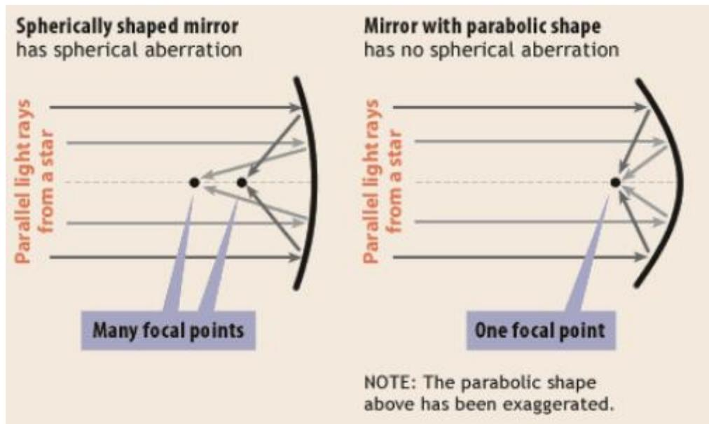
Slika 7. Sferno zrcalo (lijevo) i parabolično zrcalo (desno) [8].
