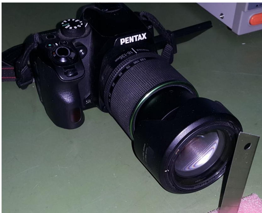
Slika 26. Kamera i oštrica skalpela u ulozi oštrog ruba.
