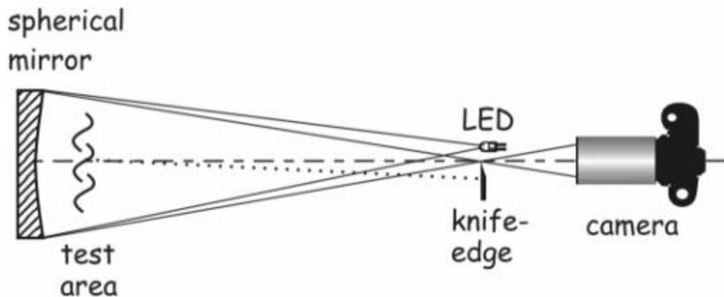
Slika 22. Schlierenova metoda s jednim zrcalom i uloga oštrogog ruba [13].
