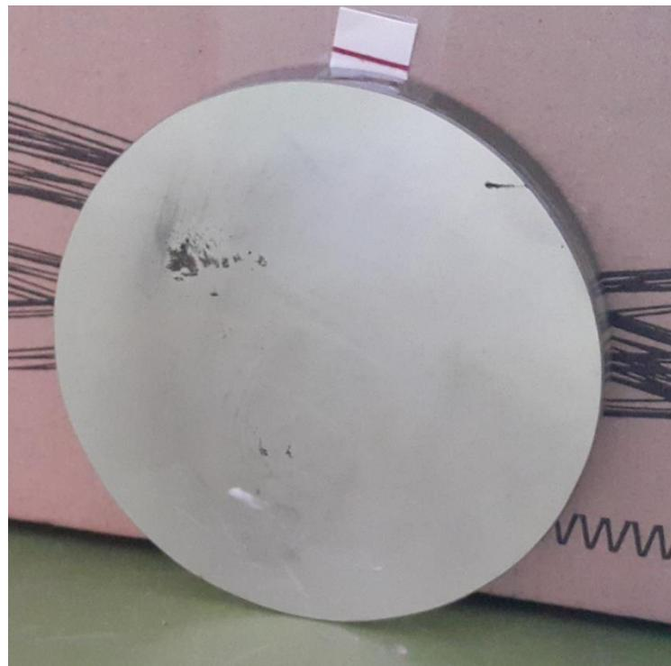
Slika 11. Parabolično zrcalo polumjera zakriviljenosti  $2f = 128$  cm. Vidljivo je malo oštećenje.
