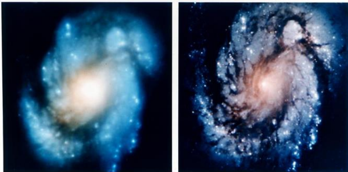
Slika 8. Slika galaksije M100 snimljena s Hubble teleskopom sa sfernom aberacijom (lijevo) i nakon korigiranja (desno) [9].
