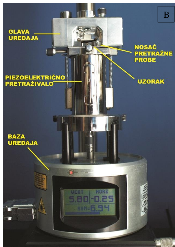
Slika 2.4. A) Uređaj AFM u Laboratoriju za biogeokemiju mora i atmosfere, Zavod za istraživanje mora i okoliša, Institut Ruđer Bošković; B) glavni dijelovi uređaja Multimode Scanning Probe Microscope s Nanoscope IIIa kontrolnom jedinicom.
