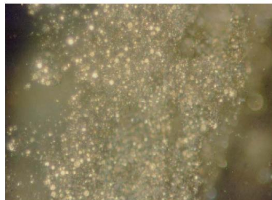
Slika 4.12 Amorfna organska tvar, VC-2 2406,0-2412,0 IV/0,02. Prolazno svjetlo. (lijevo). Reflektirano svjetlo, uljna imerzija, 330x.
