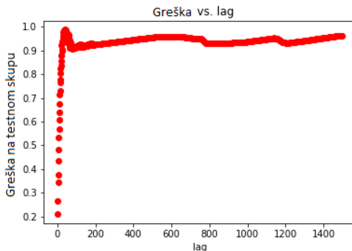
Slika 4.9: Greška modela za predviđanje stanja cijele neuronske mreže u ovisnosti o veličine mreže koju predviđamo. Greška brzo dođe do vrijednosti od 1 neurona te ne ide preko te vrijednosti. Izvor: obrada autora
