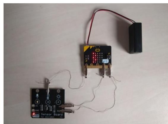
Slika 8. Postav za mjerjenje temperature vanjskim senzorom
