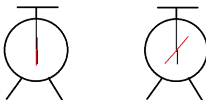
Slika 17 i 18 – nenabijeni i nabijeni elektroskop
