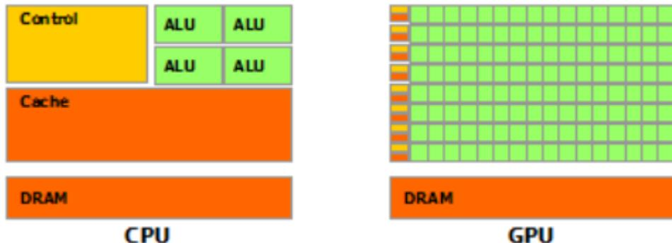
Slika 1.1: Raspored tranzistora na CPU i GPU
