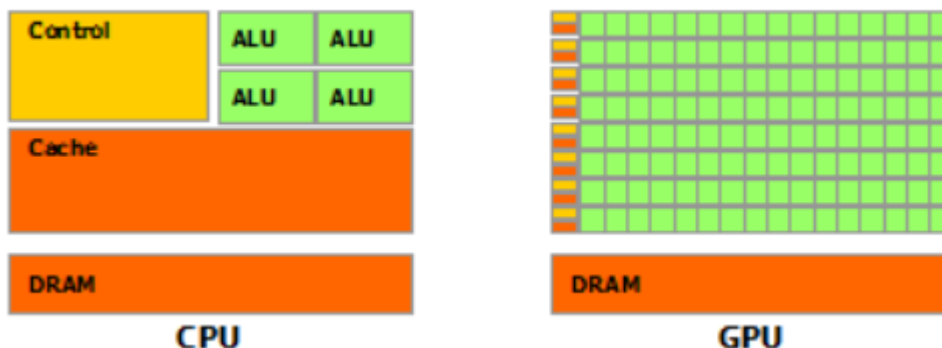
Slika 1.1: Raspored tranzistora na CPU i GPU
