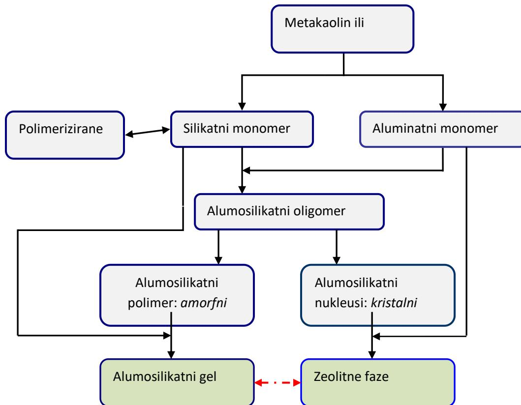
Slika 2: Prikaz redoslijeda odvijanja reakcija u geopolimernom sustavu [10]
