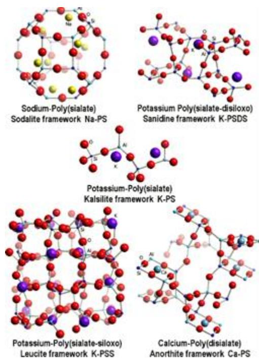
*Slika 4: Prostorne strukture ovisno o Si/Al omjeru [10]*
