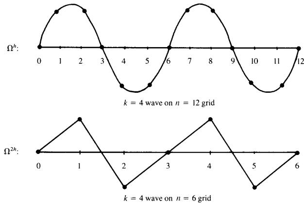
Slika 3.6: Val sa brojem oscilacija  $k = 4$  na  $\Omega^h$  ( $N = 12$ ) je projiciran na mrežu  $\Omega^{2h}$  ( $N = 6$ ). Gruba mreža "vidi" val sa brojem osilacija  $k = 4$ , koji više oscilira na grubljoj nego li na finijoj mreži.
