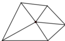
Slika 1.5. Zvezdasta triangulacija poligona
