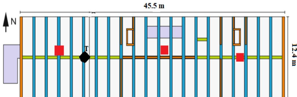
Slika 5.2: Tlocrt zgrade Geofizičkog odsjeka PMF-a s označenim točkama mjerena i procjenom položaja težišta (prema Herak, 2009).
