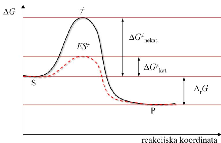
Slika 2. Shematski prikaz utjecaja enzima na Gibbsovu energiju reakcije pri čemu je S supstrat, E enzim, ≠ prijelazno stanje u nekataliziranoj reakciji,  $ES^{\neq}$  prijelazno stanje u kataliziranoj reakciji, P produkt reakcije
