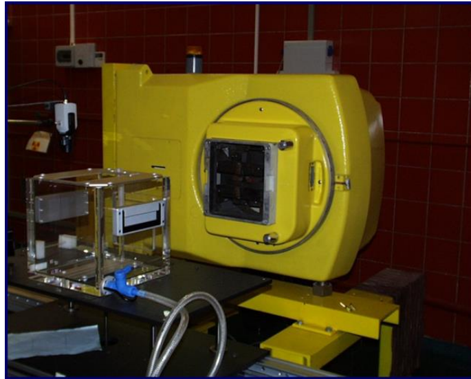
Slika 4.1.1. Radioterapijski izvor ^{60}\text{Co} Sekundarnog standardnog dozimetrijskog laboratorija Instituta Ruđer Bošković, HMI/IRB-SSDL.
