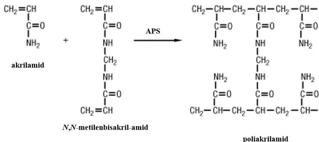
**Slika 39.** Polimerizacija akrilamida. Prikazane su strukturne formule spojeva te način na koji dodatkom APS-a akrilamidu i *N,N*-metilenbisakril-amida nastaje poliakrilamid.<sup>91</sup>
