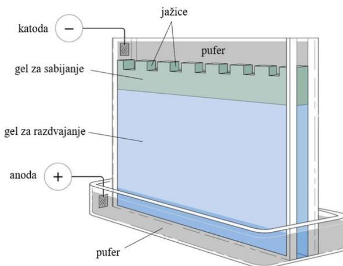
**Slika 41.** Shema uređaja za diskontinuiranu elektroforezu. Dva gela se odvojeno polimeriziraju između staklenih ploča i potom smještaju između dvaju puferskih spremnika. Uzorak se nanosi na gel za sabijanje, u kojem brže putuje i ulaskom na gel za odjeljivanje putuje na temelju molekulskog sita. Nakon završetka elektroforeze uzorci se detektiraju.<sup>95</sup>
