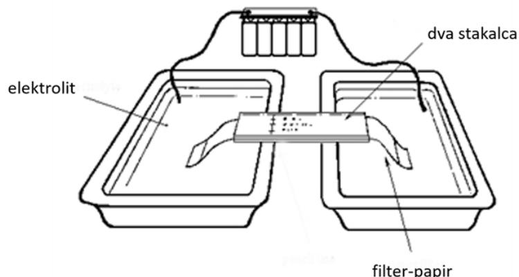
Slika 37. Shematski prikaz aparature potrebne za izvođenje elektroforeze na papiru.<sup>86</sup>
