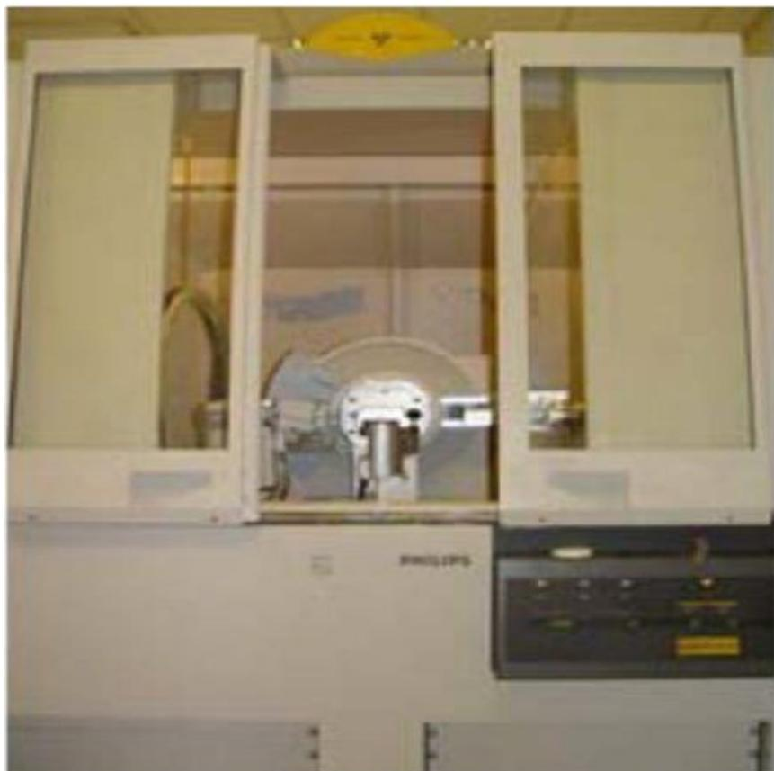
Slika 14. Rengenski difraktometar Philips PW3040/60 X’Pert Pro. Mineraloško-petrografski zavod.
