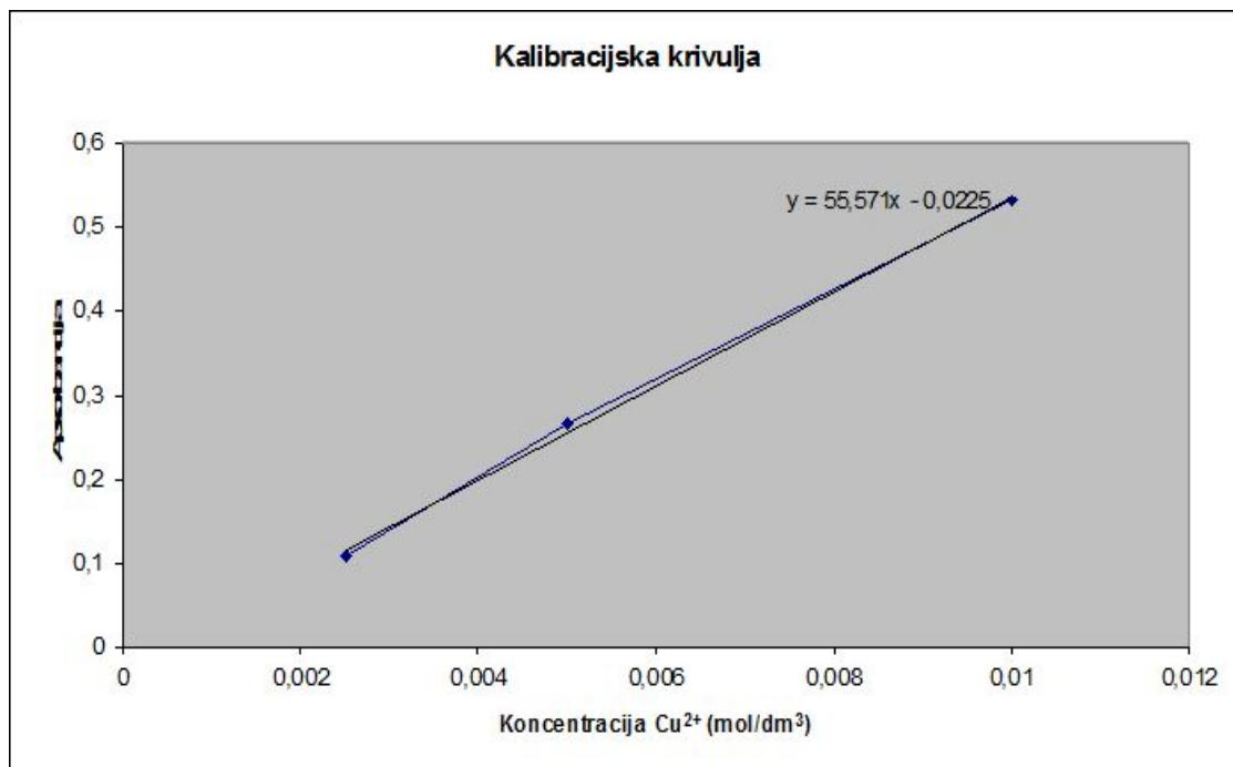
Slika 11.. Kalibracijska krivulja (baždarni pravac) konstruirana na temelju vrijednosti iz Tablice 3.
