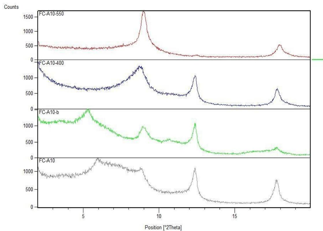
Slika 32 . Rendgenogrami orijentiranog uzorka H2 250cm; H2 250cm-550 – žaren na 550 °C, H2 250cm-400 – žaren na 400 °C, H2 250cm-b – tretirano etilen glikolom, H2 250cm– netretirani uzorak)
