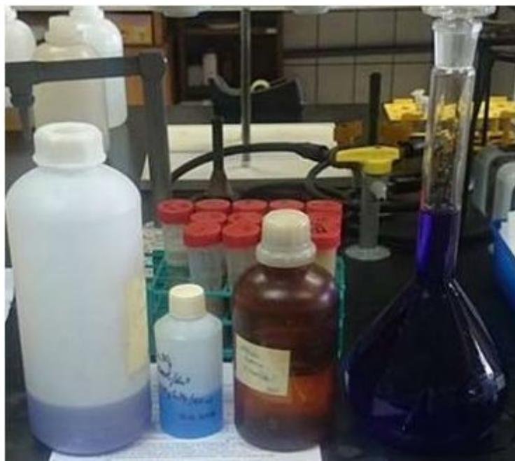
Slika 9. Pripremljeni standard za izradu kalibracijske krivulje za potrebe CEC mjerena
