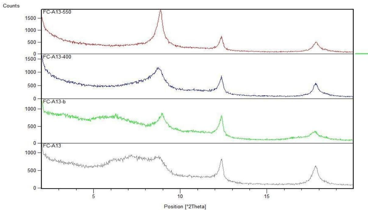
Slika 31 . Rendgenogrami orijentiranog uzorka H2 150cm; H2 150cm-550 – žaren na 550 °C, H2 150cm-400 – žaren na 400 °C, H2 150cm-b – tretirano etilen glikolom, H2 150cm– netretirani uzorak)
