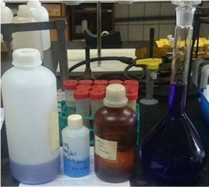
Slika 9. Pripremljeni standard za izradu kalibracijske krivulje za potrebe CEC mjerenja
