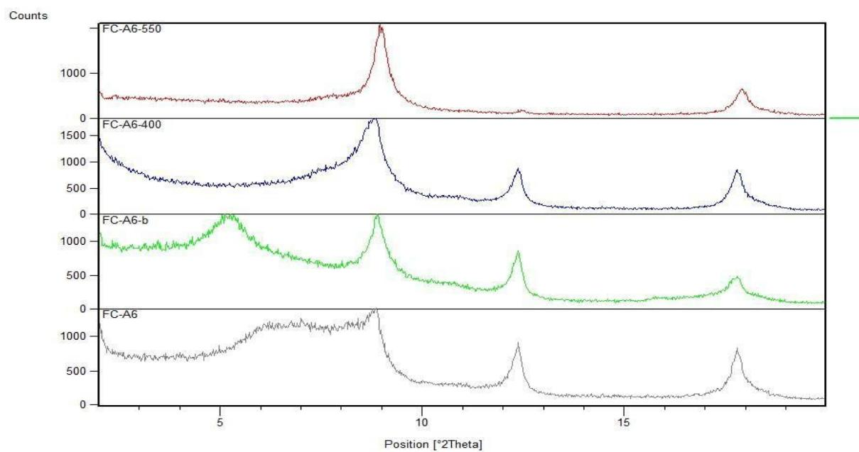
Slika 24 . Rendgenogrami orijentiranog uzorka OPO1 70cm ; OPO1 70cm-550 – žaren na 550 °C, OPO1 70cm-400 – žaren na 400 °C,OPO1 70cm-b – tretirano etilen glikolom, OPO1 70cm– netretirani uzorak)
