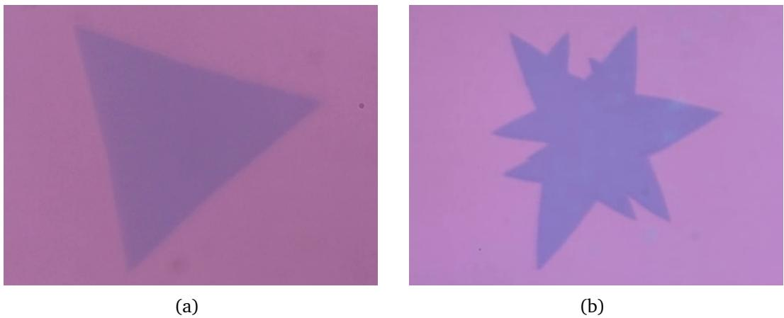
Slika 2.1: Slike dobivene optičkim mikroskopom zrna jednosloja  $\text{MoS}_2$  na supstratu  $\text{SiO}_2/\text{Si}$ , u režimu **(a)** rasta ograničenog vezanjem i **(b)** difuzijski ograničenog rasta
