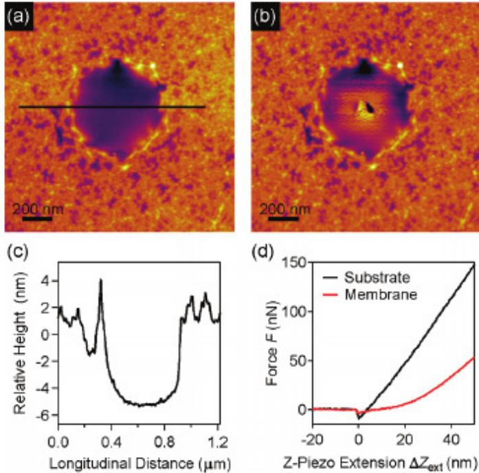
Slika 1.5: (a) prikazuje sliku dobivenu AFM-om prije pucanja i mjerena elastičnosti. (b) je AFM topološka slika nakon pucanja. (c) je graf visine za slučaj u (a). Graf na (d) prikazuje graf izmjerene slike u ovisnosti o vertikalnoj deformaciji za supstrat i MoS<sub>2</sub> membranu. Slike su preuzete iz [21]
