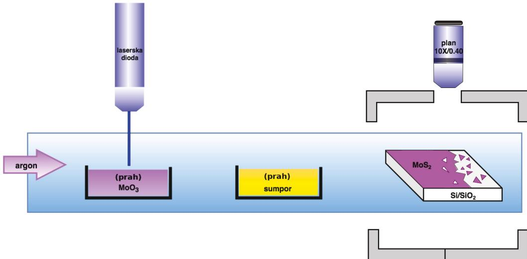
Slika 2.4: Shematski prikaz postava za sintezu MoS<sub>2</sub>. Temperatura na koju se dovede postolje za sumpor je 130°C, a sinteza se odvija na 700-800°C s protokom od 100 sccm. Valna duljina lasera je 450 nm.
