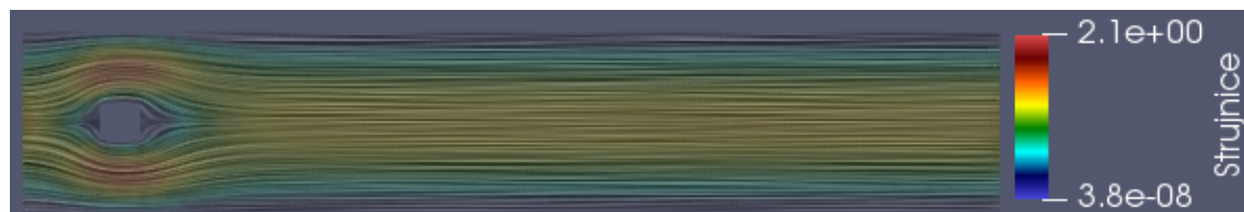
Slika 1.9: Prikaz strujnica u trenutku t=10 , Re=16 ; Tok je stabilan laminaran
