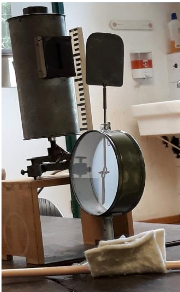
Slika 4.: Postav za demonstraciju fotoelektričnog efekta na fakultetu.
