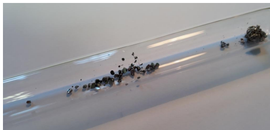
Slika 5.1.3: Fotografija ampule s Cd 3 As 2 nakon završene sinteze. Izrasli kristali su izolirani i koncentrirani su oko sredine ampule, gdje je u trenutku početka sublimacije početnog materijala temperatura bila najniža.
