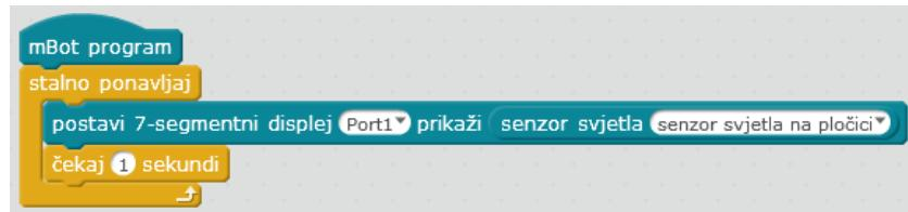
Kada je svjetlo ugašeno senzor svjetlosti daje vrijednosti od 0 do 50. Kada je svjetlo upaljeno senzor svjetlosti daje vrijednosti veće od 50.
