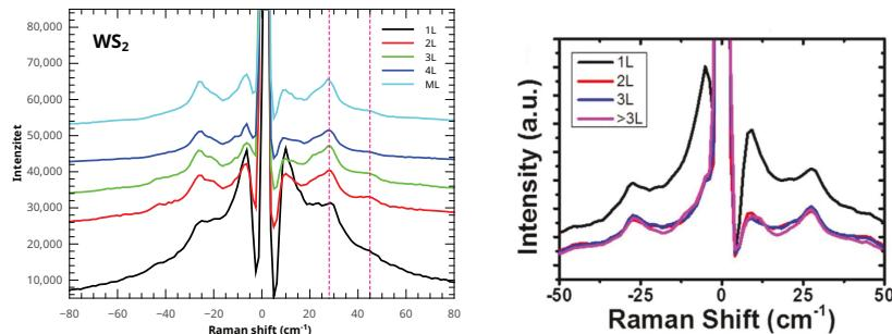
Slika C.3: Niskoenergetski Ramanov spektar CVD naraštanog  $\text{WS}_2$ , lijevo: izmjereno u Laboratoriju za lasersku mikroskopiju Institut za fiziku, desno: preuzet iz [83].
