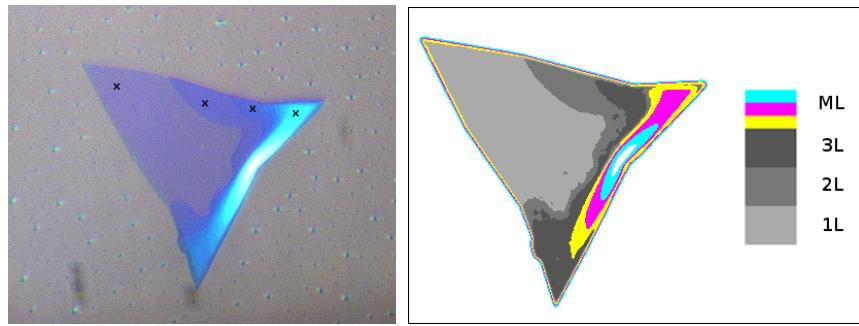
Slika 3.6: Lijevo: Optička slika CVD naraštane WS<sub>2</sub> fleke s različitim brojem slojeva. "X" označava položaje na uzorku gdje su se snimali Raman spektri prikazani na Slici 3.7. Desno: Obrađena slika pod a) napravljena je pomoću programskog jezika *Python*. Različite boje odgovaraju različitim debjinama materijala.
