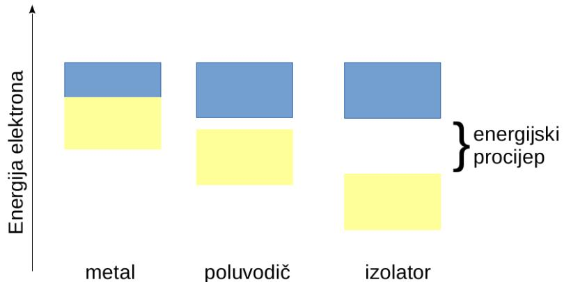
Slika 1.3: Shematski prikaz valentne (žuto) i vodljive (plavo) vrpce. Kod metala se one preklapaju dok su kod poluvodiča razdvojene nekoliko eV, a kod izolatora više od 5 eV.
