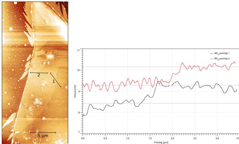
Slika A.6: Lijevo: Slika CVD naraštanog  $\text{WS}_2$  uzorka snimljena pomoću AFM-a. Desno: Visinski profili naznačenih dijelova na slici a).
