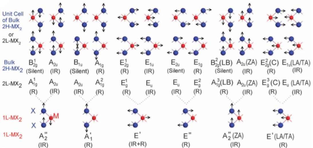
Slika 1.7: Simetrija i normalno pomicanje svakog moda optičkih vibracija za cjeloviti  $\text{MX}_2$ , dvoslojni (2L)  $\text{MX}_2$  i jednoslojni (1L)  $\text{MX}_2$ . Posebno su naznačeni Raman-aktivni (R), infracrveno aktivni (IR) i tihi modovi. Isprekidane linije pokazuju da je svaki način titranja u 1L-MX<sub>2</sub> podijeljen na dva načina titranja u 2L-MX<sub>2</sub> i MX<sub>2</sub> od kojih jedan vibrira u fazi i drugi van faze. Preuzeto iz [46].
