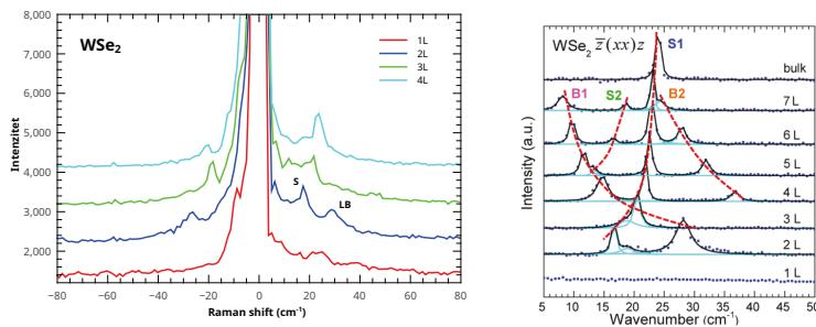
Slika C.4: Lijevo: izmjereni niskoenergetski Ramanov spektri mehanički eksfoliranih  $\text{WSe}_2$  uzoraka. Desno: Niskoenergetski Ramanov modovi  $\text{WSe}_2$  različitih debljina preuzet iz [48]. Snimljen je u  $\bar{z}(xx)z$  polarizacijskoj konfiguraciji. Crvena krivulja je vodilja oku koja pokazuje ovisnost položaja niskoenergetskih modova o broju slojeva materijala.
