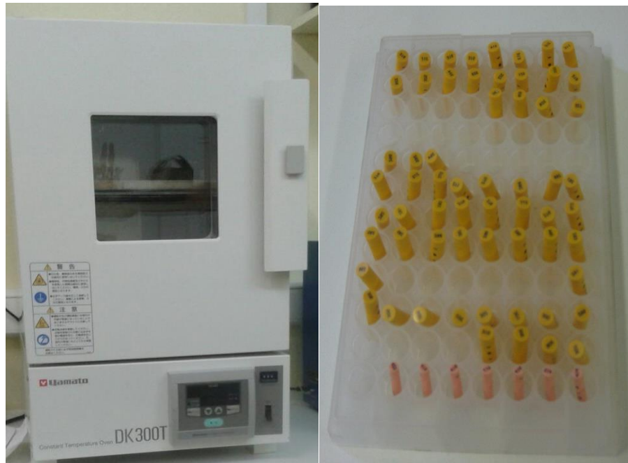
Slika 3.13 Peć za predgrijavanje DK 300T Constant Temperature Oven i plastični držač za dozimetre [12]
