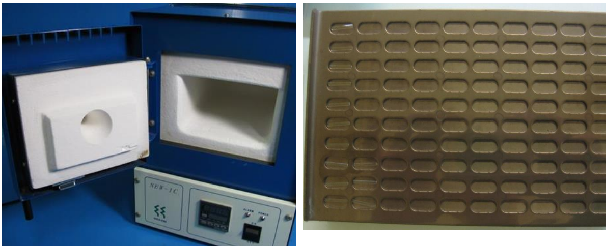
Slika 3.6 Peć za aniliranje (lijevo) i metalni držač (desno) [12]
