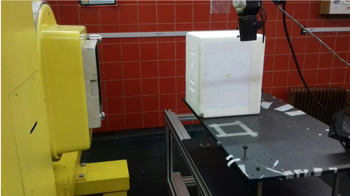
Slika 3.12 Prikaz izvora ^{60}\text{Co} i dozimetra prilikom mjerenje kutne ovisnosti
