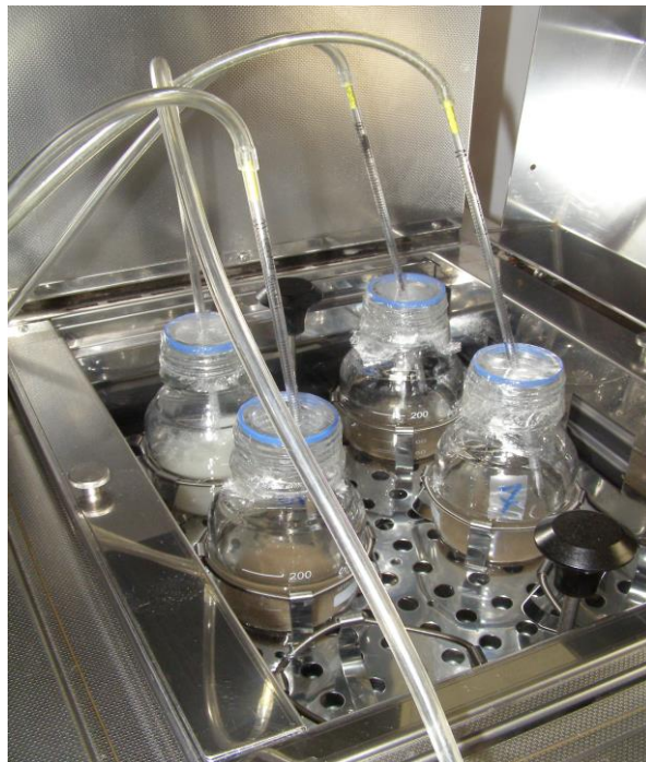
Slika 4. Vodena kupelj s uzorcima.
