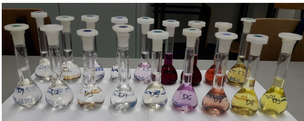
Slika 16. Otopine kroma(VI) za analizu UV/Vis spektrofotometrijom
